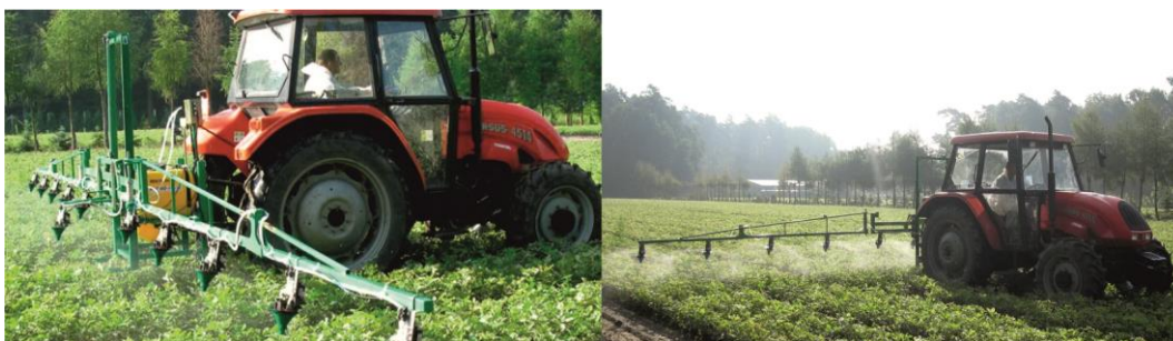
Рис. 7. Опрыскиватель Micromax с роторным распылителем [16]
