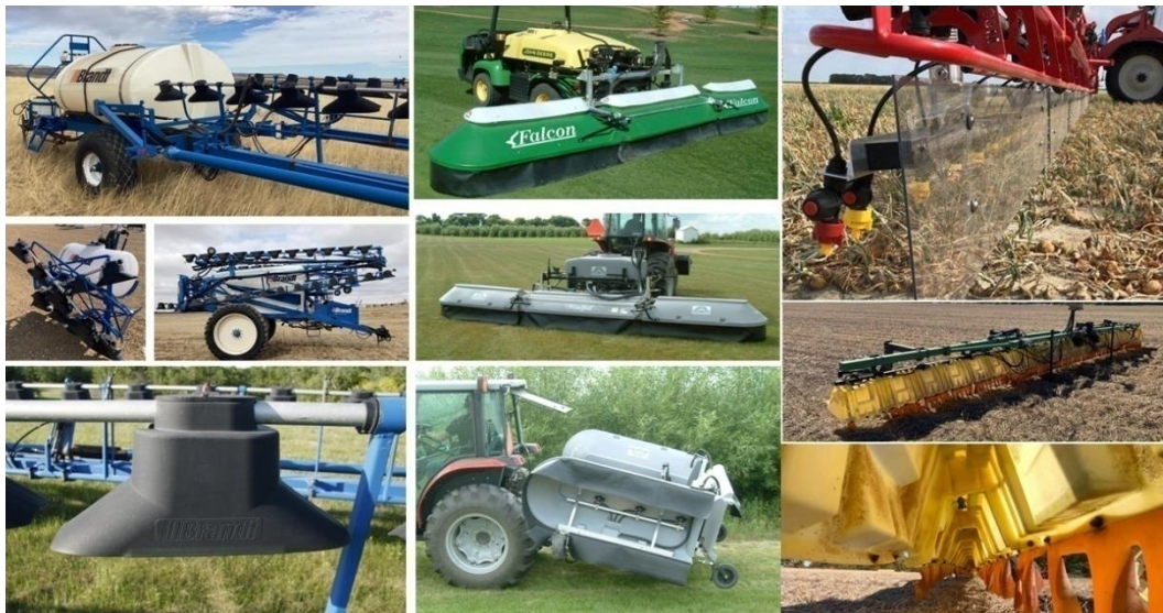
Рис. 3. Опрыскиватели с ветрозащитными устройствами пассивного действия
