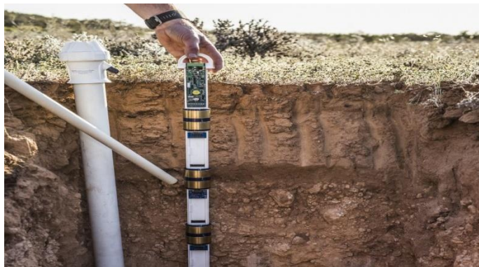
Рис. 1. Сенсорный датчик Sentek EnviroSCAN
