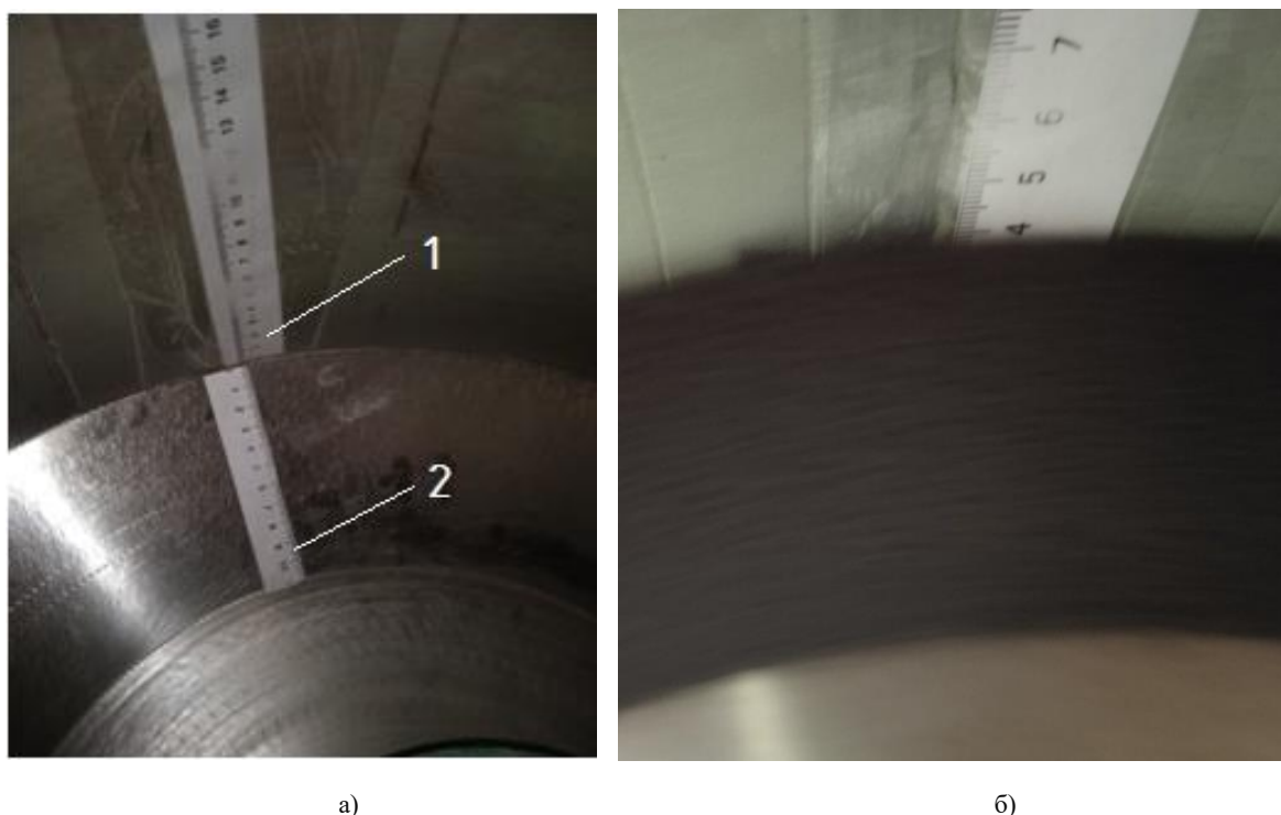
Рис. 1. а) Общий вид шкал, б) Движение семян внутри камеры смешивания: 1 – Шкала высоты подъёма на стенке камеры смешивания; 2 – Шкала длины образующей конуса подвижного днища
