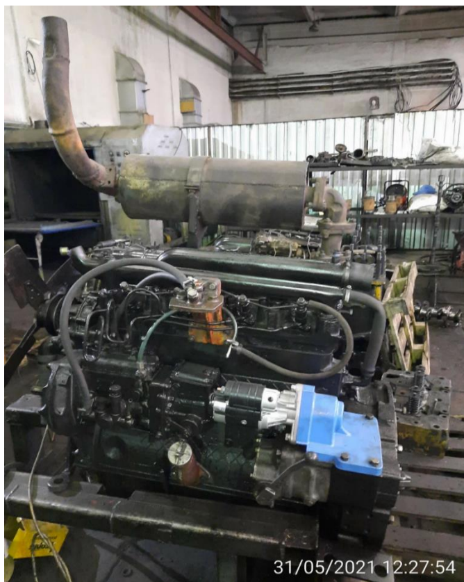
Рис. 4. Стендовые испытания магнитного активатора топлива
