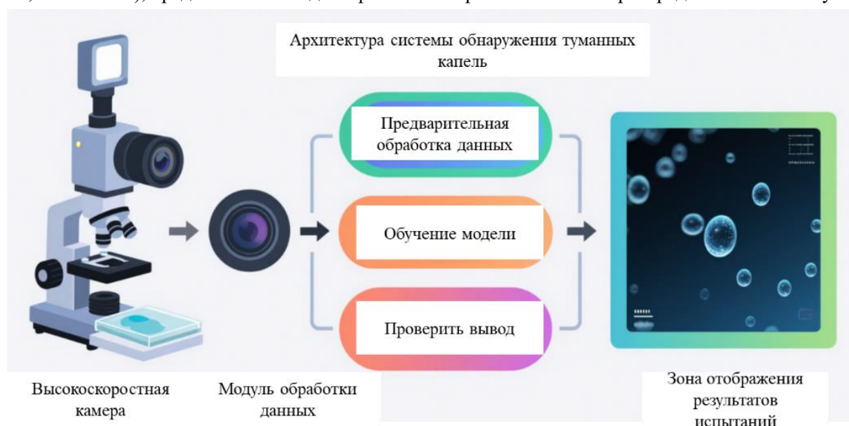
Рис. 2. Архитектура системы обнаружения капель тумана
