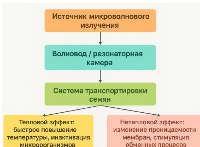
Рис. 2. Схематическое представление механизма действия микроволновой предпосевной обработки
